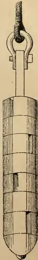
Fig. 15. Contre-poids sur leur tige centrale.
